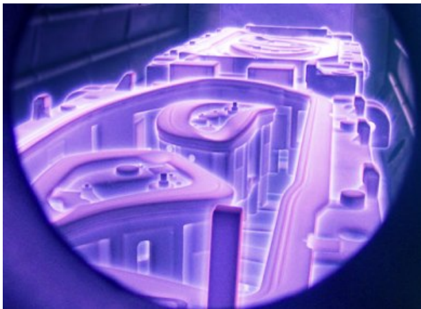
Bild: Blick durch ein Sichtfenster auf ein unter Plasma stehendes Aussenhautwerkzeug
